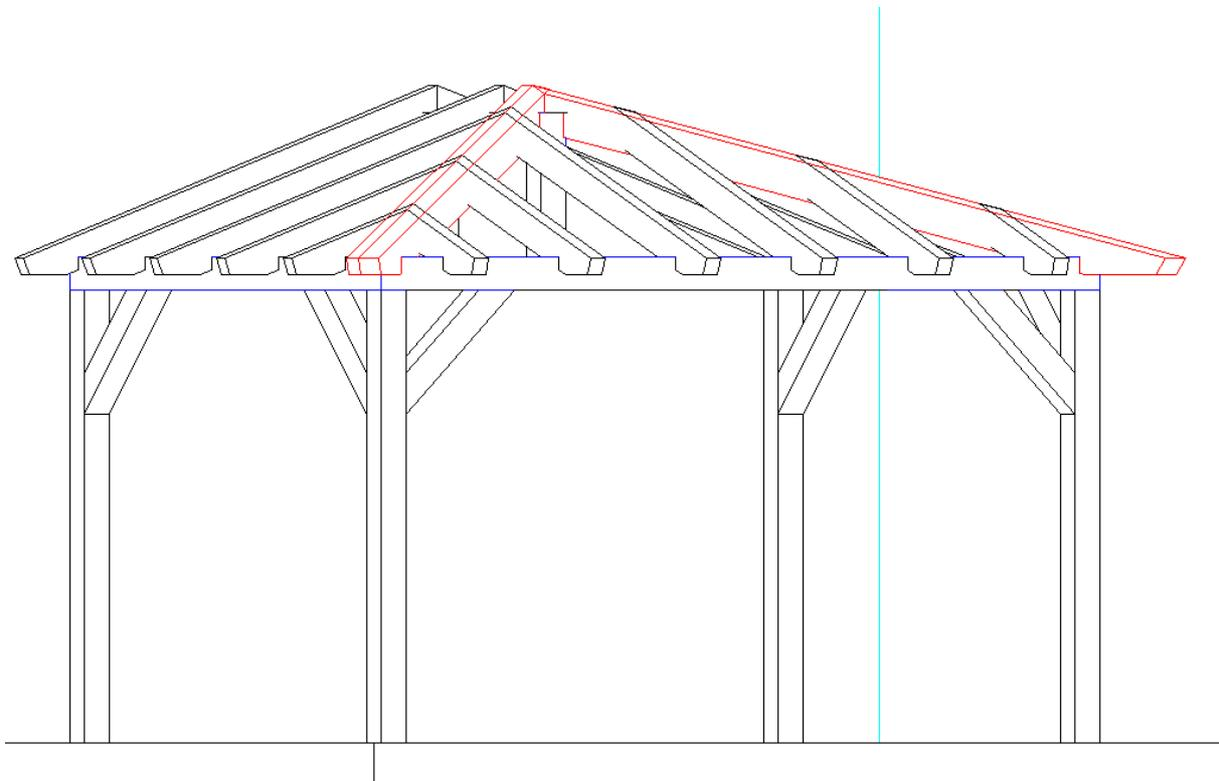
Vordach/ Überdachung mit Walmdach (flach)
