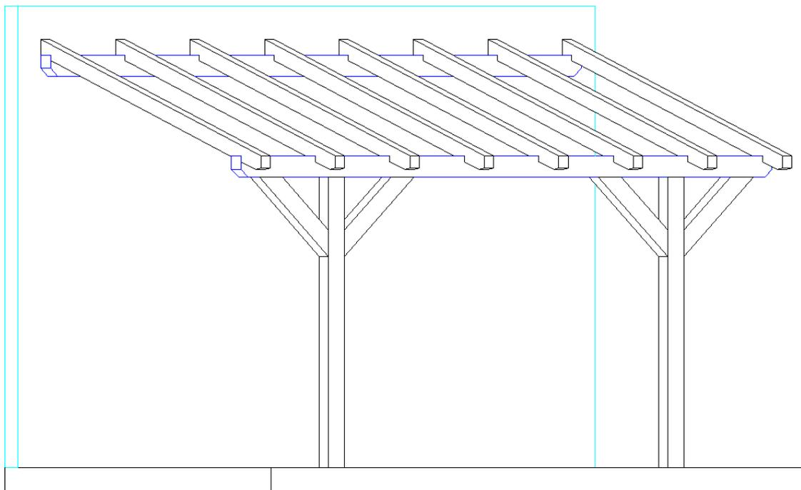
**Einfache Überdachung mit Pultdach- freistehend**
